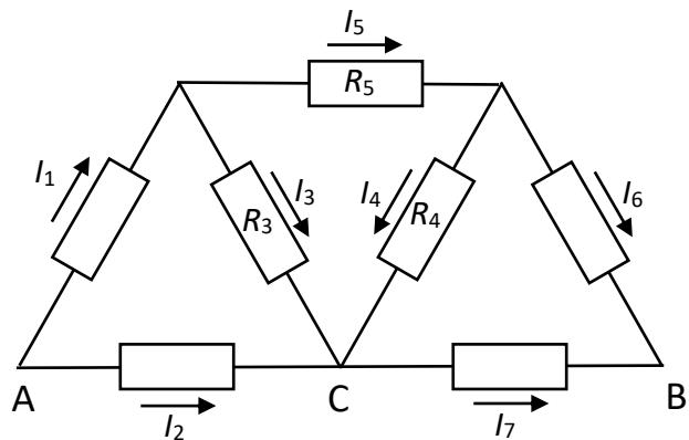
S obzirom na to da su svi otpornici jednaki, iz simetrije problema vidljivo je da su struje  $I_1 = I_6$  i  $I_2 = I_7$  pa su stoga i struje
